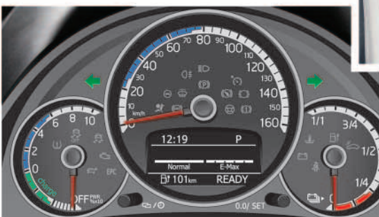
Schalttafeleinsatz mit e-spezifischen Anzeigen
